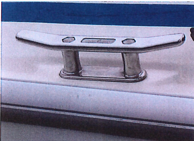
Nicht jeder Zurpunkt/jede Klampe ist für die Ladungsicherung geeignet. Festigkeit der Bauweise und der Befestigung sorgfältig prüfen. Augenscheinlich stabiler und geeigneter Zurpunkt/Klampe.
